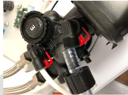
1. Abwasserschlauch 1/2" aufschieben und mit der Schlauchschelle festklemmen.
