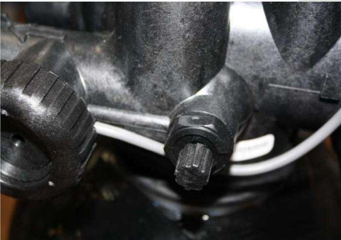
1. Verschneide Ventil am Steuerkopf zum Verschneiden der Restwasser Härte.
